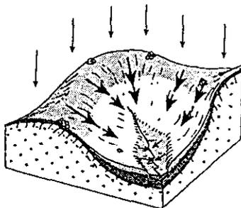
Si la pluie continue, des volumes saturés apparaissent là où les sols sont les plus minces, en haut de versant. Mais l'eau qui y ruisselle s'infiltré immédiatement en aval ; si elle contribue à l'alimentation de la nappe et à l'extention des surfaces saturées, elle ne contribue pas à l'écoulement rapide, et les débits demeurent très faibles.
